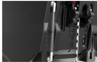
Indicateur du niveau du réservoir de solution
